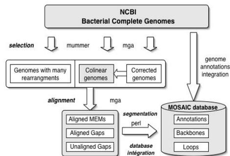
Représentation schématique du traitement des données dans la base MOSAIC. Les génomes ne comportant pas de réarrangements sont sélectionnés en utilisant Mummer puis alignés avec MGA. Ils sont ensuite segmentés et intégrés dans MOSAIC.
